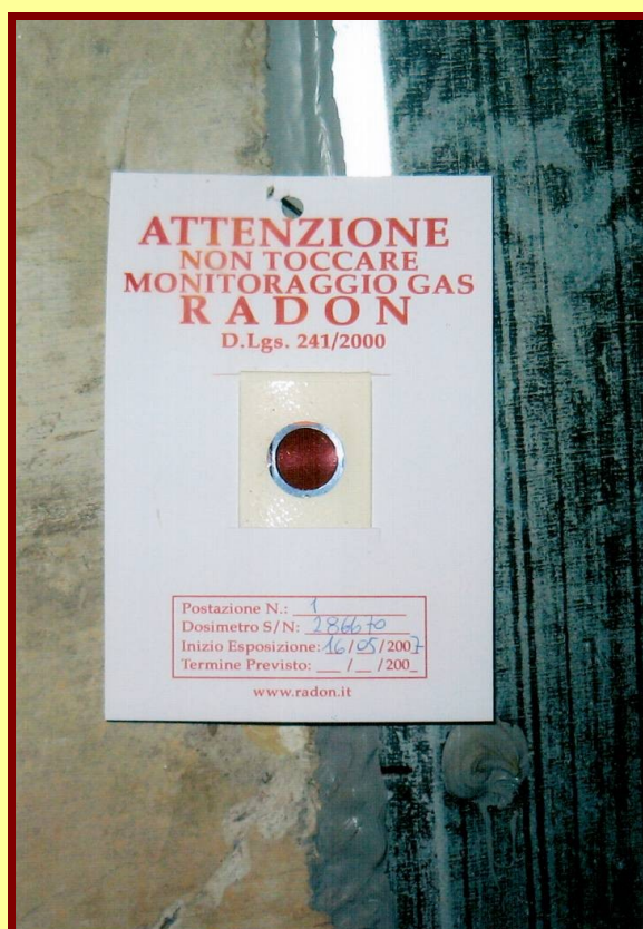
Particolare del dosimetro per misurare il gas radon.
